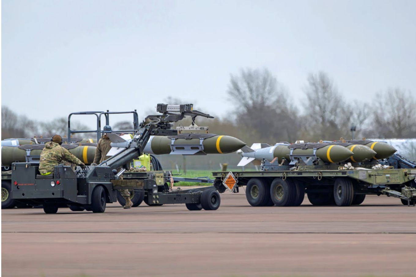
Bone'u Yükleme Havacılar, BLU-109 mühimmatlarını nakliye römorklarından bir B-1B Lancer'a aktarmak için bir MJ-1 kaldırma aracı kullanıyor. Mühimmat zincirinin bu son halkası, Operation Epic Fury sırasında gereken hızlı sorti oranlarını korumak için kritik öneme sahiptir.
