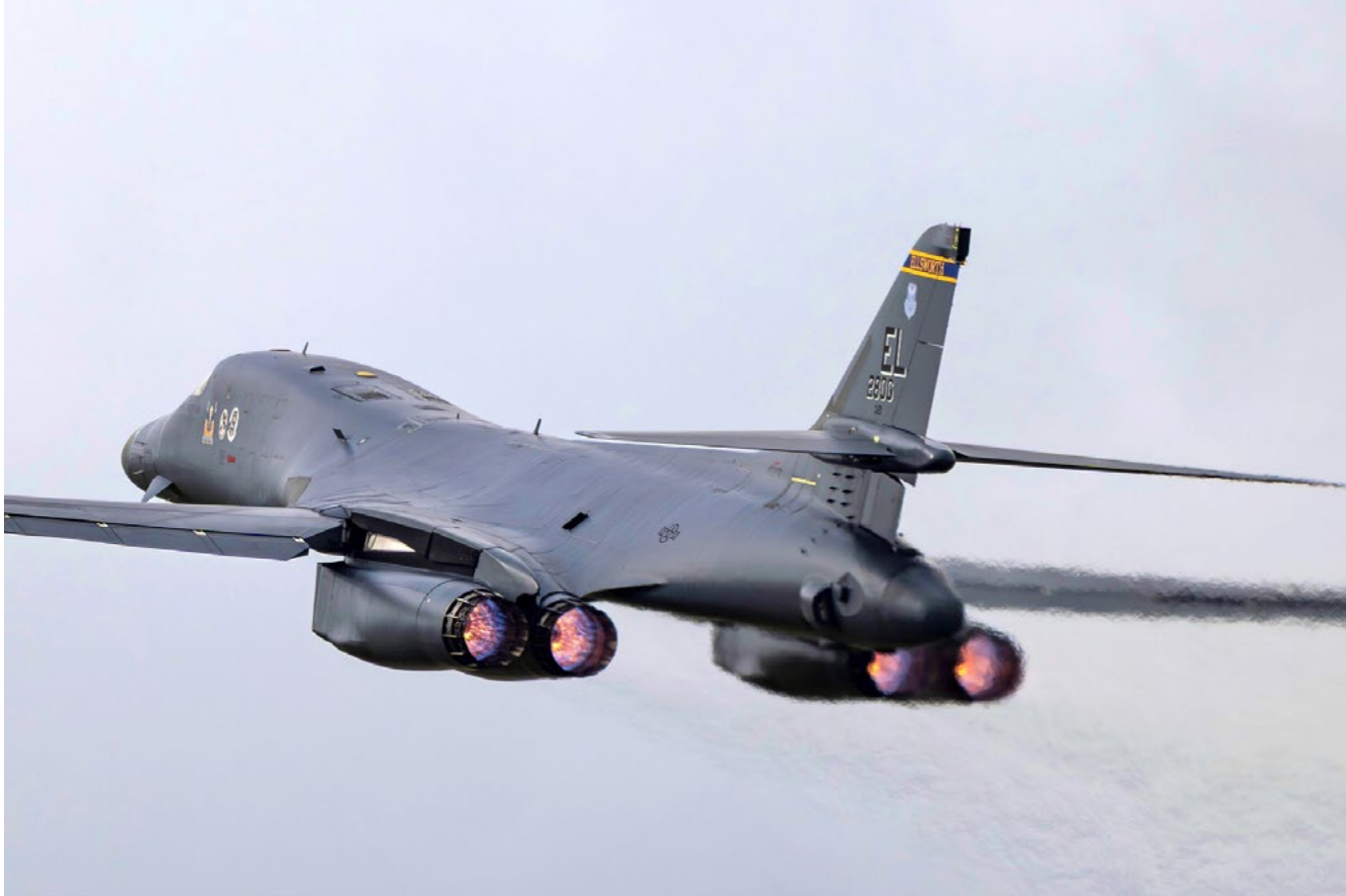
Tam Art Yakıcı Dört GE F101 motorunun tamamı art yakıcı modundayken havalanan B-1B Lancer'ın ham gücü tüm çıplaklığıyla gözler önüne seriliyor. 28. Bombardıman Filosuna ait bu "Bone", uzun süreli bir görev için tırmanışa geçtiği sırada devasa bir ısı izi oluşturuyor.
