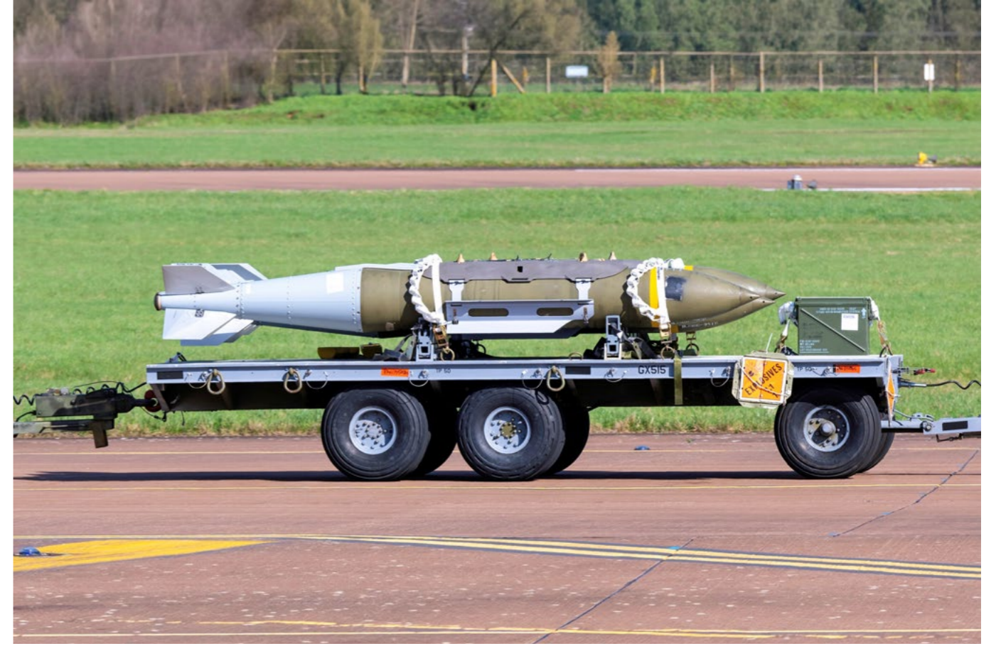
Uzaktan Vuruşa Hazır 2026 Bombardıman Görev Gücü'nü desteklemek amacıyla RAF Fairford'a sevk edilen yüzlerce hassas güdümlü mühimattan biri. GBU-31, B-1B mürettebatının yerel nokta savunma sistemlerinin doğrudan erişimi dışında kalarak, tek bir geçişte birden fazla hedefi imha etmesine olanak tanır.
