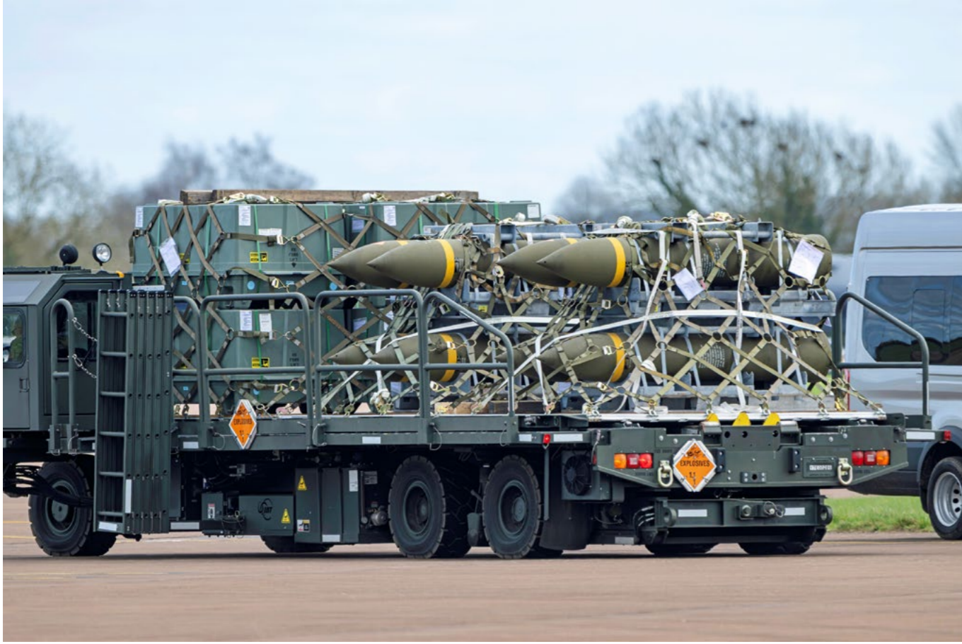
Mühimmat Hazırlığı Bir Halvorsen yükleyici, bir BLU-109 bomba gövdesi ve bileşen sandığı ikmalini RAF Fairford apronu boyunca taşıyor. Bu "demir bombalar", B-1B Lancer'ın konvansiyonel vuruş görevini tanımlayan hassas güdümlü mühimmatların temelini oluşturuyor.
